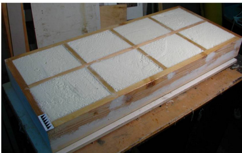
Рис. 4 Вид с тыльной стороны после запенивания полостей несущей конструкции. Авторский снимок
